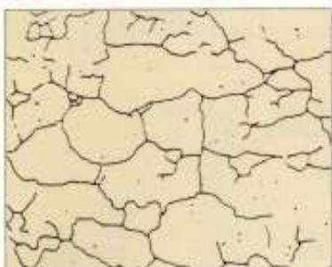
アルカリ骨材反応によるコンクリート表面のひび割れ
